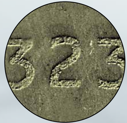
Visualisierung der magnetischen Struktur einer Seriennummer
