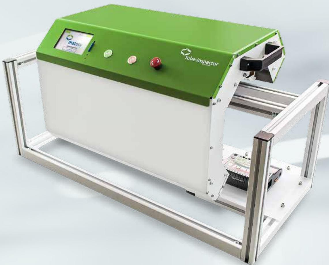
Der tube-inspector ist ein automatisiertes System zur geometrischen Vermessung von Rohrtargets und Magnet Bars. Das System wurde für die Analyse beschichteter Rohre und Leitungen (bspw. rotierende Targets) vor und während des Produktionsprozesses entwickelt. Hierzu gehören Aussagen über die Qualität des Prozesses sowie die Lebensdauer der Targets.
