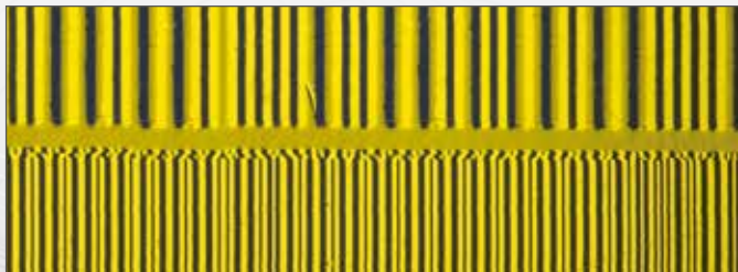
Abbildungen: Visualisierung der magnetischen Struktur von Linearencodern
